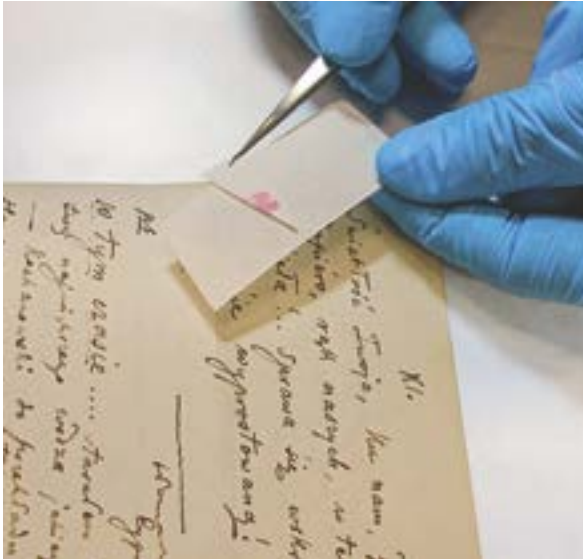
Fot. 2. Fotografia wskaźnika wybarwionego podczas badania stanu zachowania rękopisu w Centralnym Laboratorium Konserwacji Archiwaliów. Fot. AGAD/CLKA
